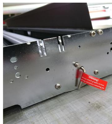
4 Legen Sie den Druck zu sich vor die Kassette, Sie können ihn dazu aufrollen. Entfernen Sie den Klebestreifen auf der Achse und öffnen Sie die Klemmschiene. Greifen Sie sie an der oberen Kante und ziehen Sie sie in Ihre Richtung. Jetzt kann der Druck aus der Kassette entfernt werden.
