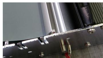
5 Öffnen Sie die obere Klemmschiene und entfernen Sie den Druck.
